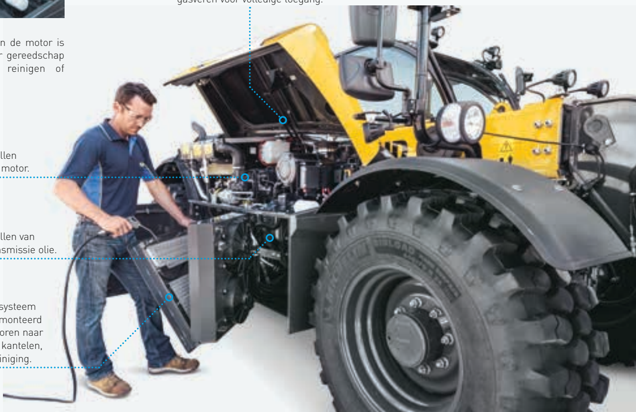
De motorkap gaat omhoog met gasveren voor volledige toegang.
